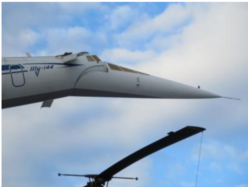
Aquí se aprecia claramente que "el pico" es móvil. Fijaos justo debajo de las ventanillas...
