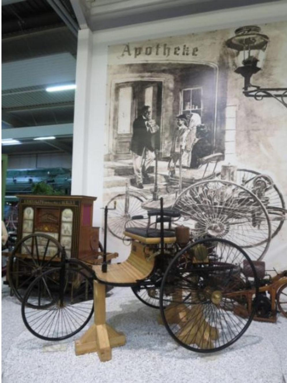
El Benz 1886, el primer vehículo a motor de combustión de la historia. Un litro de cilindrada, 10 litros de consumo a los 100 y 16 km/h de velocidad máxima. Esta réplica funciona de verdad.
