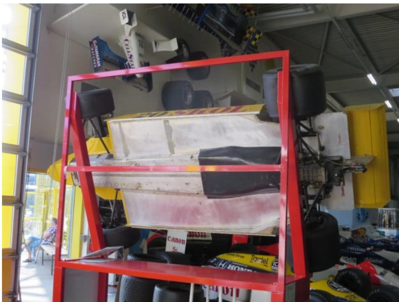
El fondo con forma de "ala invertida", los famosos Wing-Car que marcaron toda una época en la F1. Aquí podemos ver el del Fittipaldi-Skol F8 de 1981
