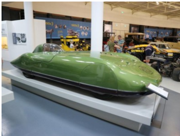
Con el MG EX179 de 1954 y con sólo 918 cc se alcanzaron los 274 km/h. suficientes como para quedarse sin puntos en tres vidas y media.
