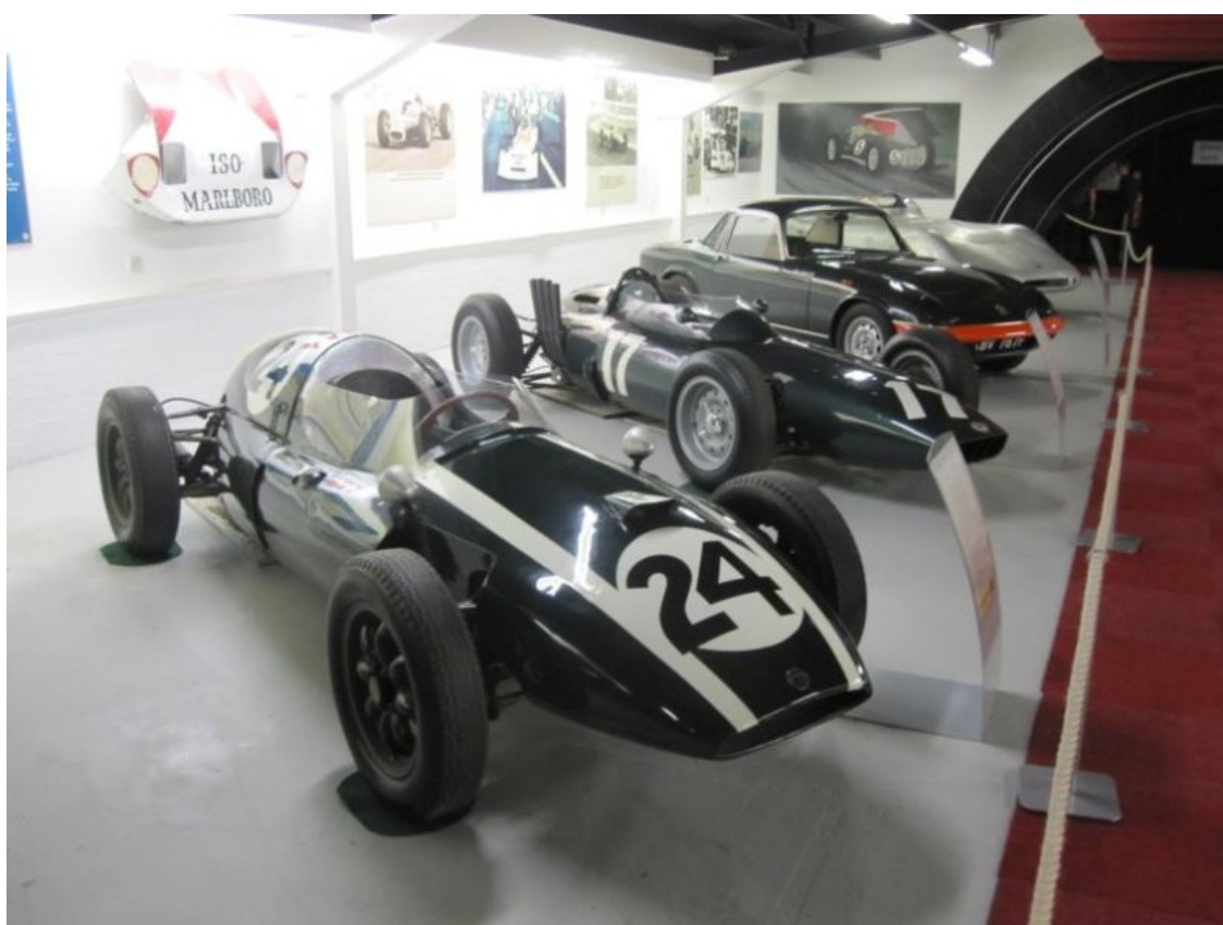
Otro campeón del mundo más. El Cooper Climax T51 (1959) de Jack Brabham Este coche, vencedor en el GP de Mónaco de 1959, fue el primer monoplace de F1 con motor trasero. En segundo plano, el BRM de 1961, mucho menos brillante.
