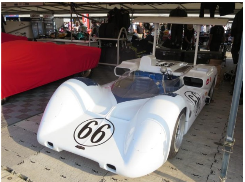
Otro coche mítico de veras, el Chaparral Chevrolet 2E de 1966 Aunque solo obtuvo una victoria en el campeonato Can-Am (Laguna Seca con Phil Hill al volante) se ha ganado su lugar en la historia por ser el primer modelo en pasar los radiadores a ambos lados del habitáculo y, sobre todo, por incorporar un alerón elevado y móvil para mejorar el agarre en pista. Creó escuela e incluso los Fórmula 1 llegaron a incorporar tales artilugios. Lástima que el reguero de accidentes que provocaron en pocos años causaran su prohibición. En España conocimos el Chaparral gracias a que Scalextric lo llevó a sus pistas.
