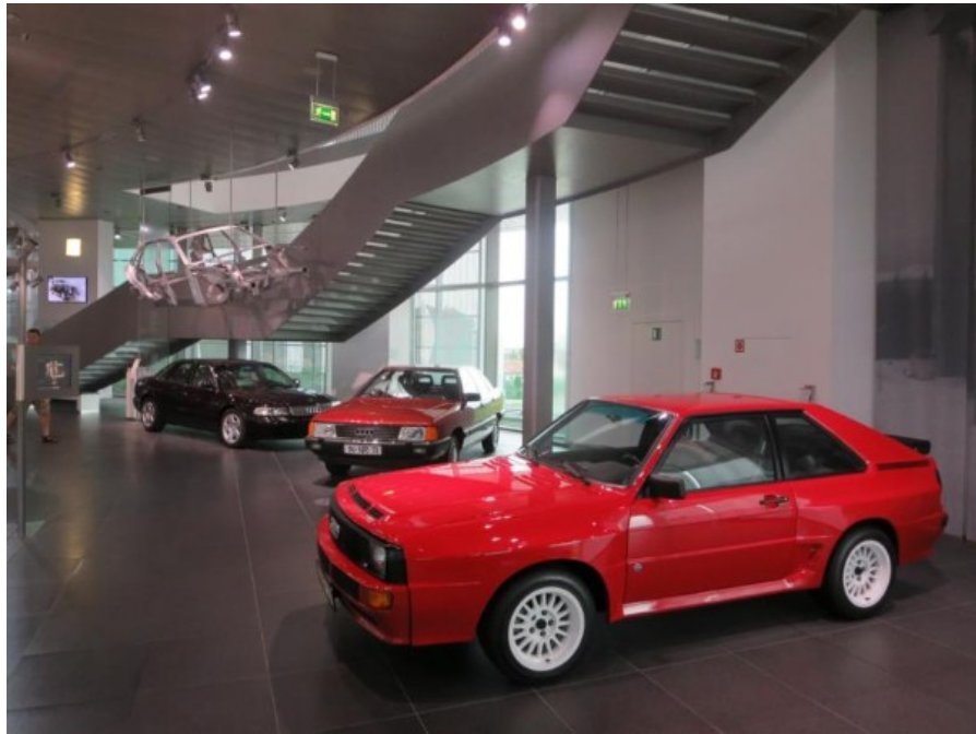
El Audi Sport Quattro de 1983, el coche de producción más rápido de Alemania, 306 cv Alcanzaba los 250 km/h. Dotado con carrocería de kevlar y fibra de carbono, solamente se fabricaron 214 uds.
