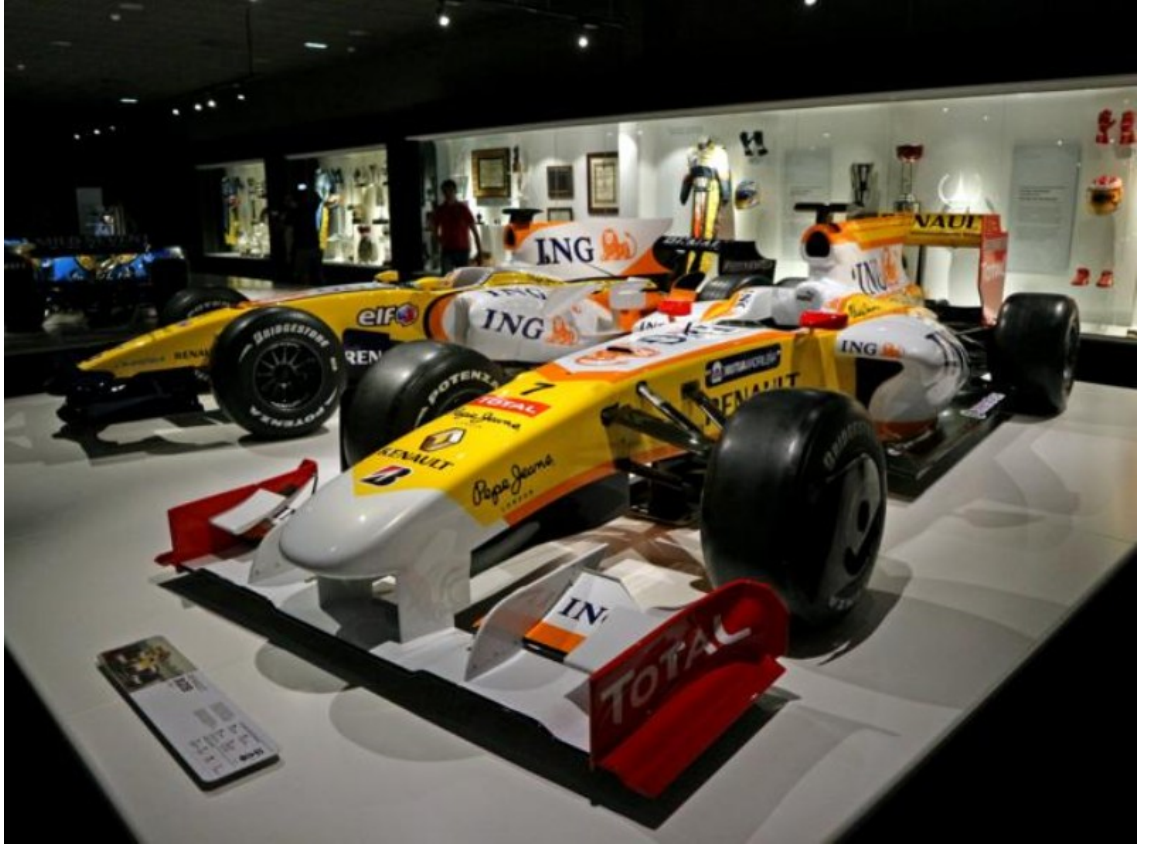
El RS29 de 2009. No fue ni de lejos el mejor coche que ha pilotado Fernando, pero sí el primero en lucir el ancho alerón delantero que caracterizó la aerodinámica de la temporada. Aquellos monoplazas se ganaron el mote de "cosechadoras"
