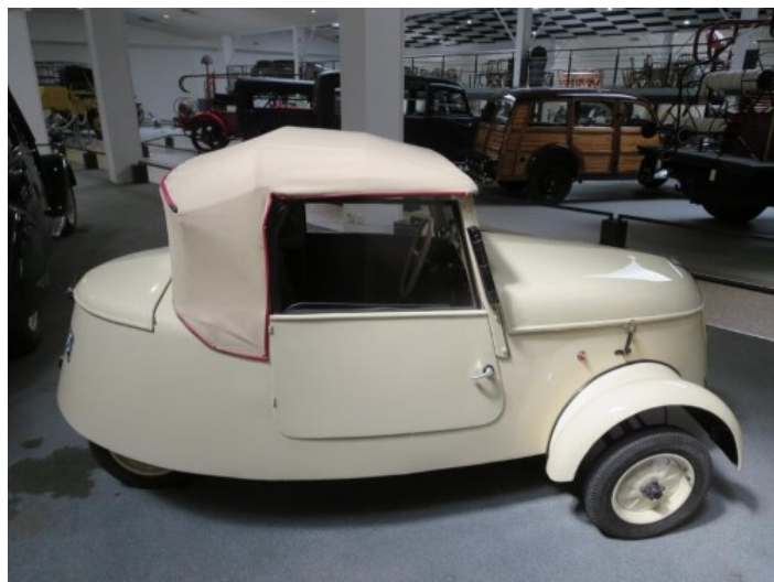
SK3 "Boulangère" (Panadero) de 1937 Esta camioneta, basada en el modelo 302, podía transportar hasta 800 kg.
