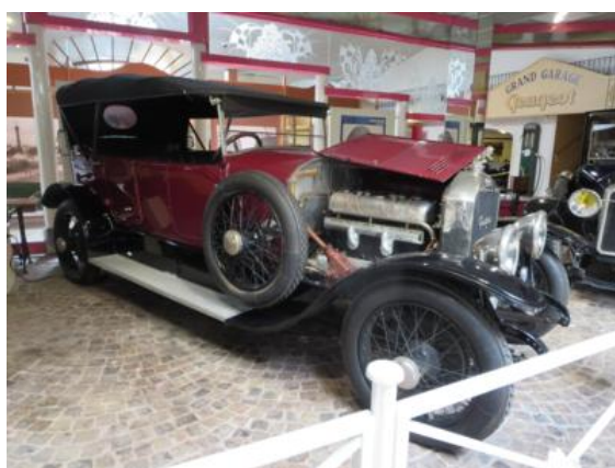
El Type 156 Torpedo de 1913 es un compendio de tecnología y el primer modelo fabricado en Sochaux. Este coche equipó el primer motor "diésel" de Peugeot
