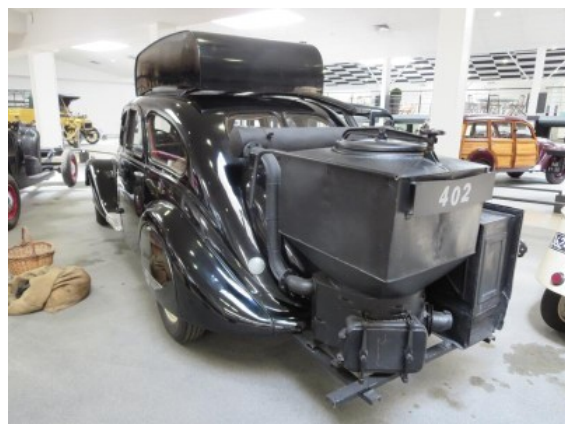
Las penurias de la guerra y la escasez de combustible agudizaron el ingenio. Quemando carbón se podía hacer funcionar un coche. Durante la guerra, 2.500 Peugeot fueron equipados con este sistema.
