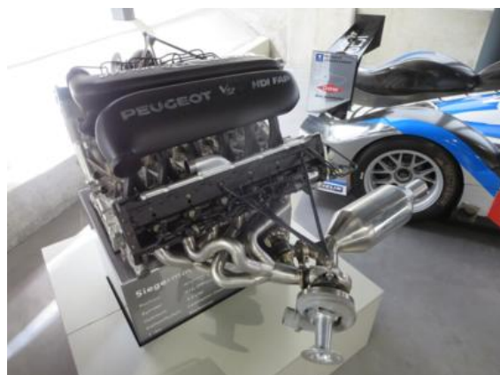
El motor V12 HDI FAP, vencedor de las 24 de Le Mans en 2009
