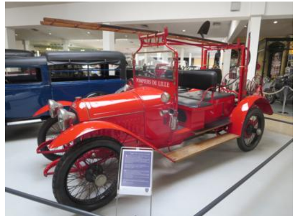
Camión de Bomberos Type 153 (1915) dotado de depósito de agua y mangueras. Sirvió en la zona de Lille, durante la Gran Guerra
