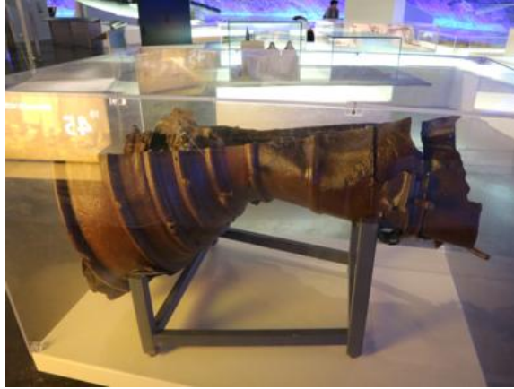
Fragmento del reactor de una V-2
