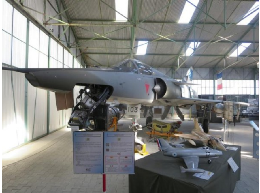
Mirage III RS de reconocimiento (Francia/Suiza) Bajo el morro se aprecia el compartimento reservado a las cámaras
