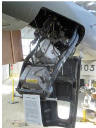
Aquí se aprecian mucho mejor las cámaras de reconocimiento
